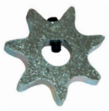
TR 2016 Engrenagem aço 1020 7D esp. 6,35 mm ø 10,00 x 33,00 mm asa 40/1
