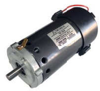
AT 1300 Motor imã permanente 24Vcc 300W 2900 RPM 63B14 Ø 77,3 CW/CCW
