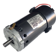
AT 1501 Motor imã permanente 150Vcc 500W 2500 RPM 63B14 Ø 77,3 CW/CCW
